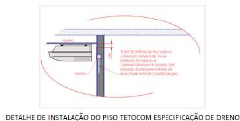
Figura 8: detalhamento do sistema de dreno piso teto
